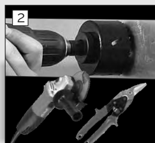
2. Wykonaj otwór dowolnym, narzędziem
