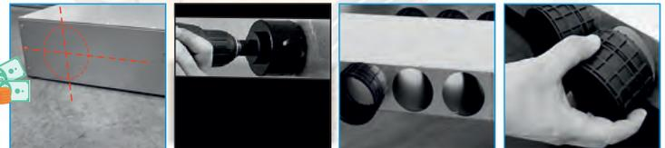
Markieren Sie die Mitte des Lochs. Bohren Sie das Loch mit einer Metallbohrmaschine. Montieren Sie die Armatur. Und fertig!
